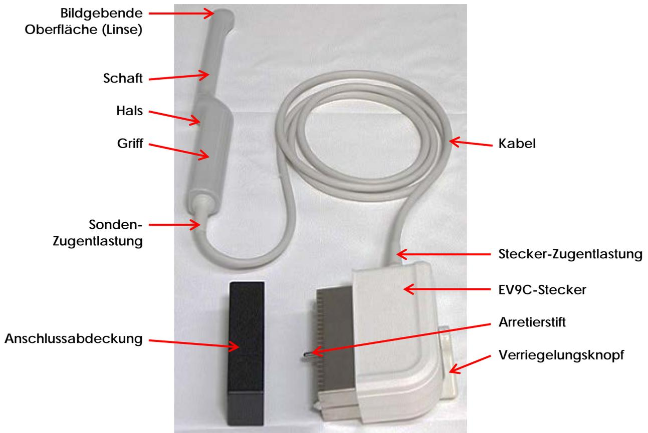
Abbildung 1: Exact Imaging EV9C-Sonde
